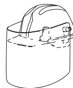
CASCO DE SEGURIDAD con pantalla antiproyecciones Visor abatible
